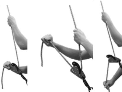
La corde libre en sortie du dispositif doit toujours être tenue et freinée
